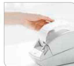
La transmisión no es manual: los valores de medición se envían a la impresora seca 360° wireless y se imprimen inmediatamente.
