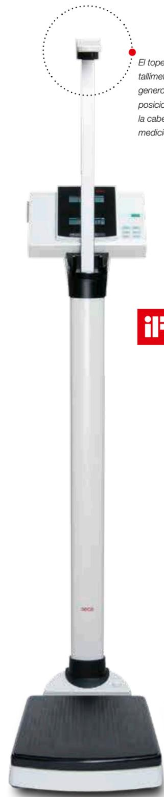
El tope para la cabeza del tallímetro, de dimensiones generosas, asegura el posicionamiento exacto de la cabeza, y con ello una medición precisa.
